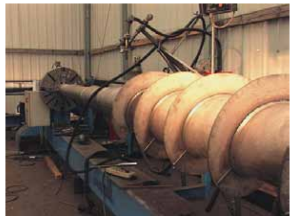
Bild 4 Hartauftragung von Förderschnecken
