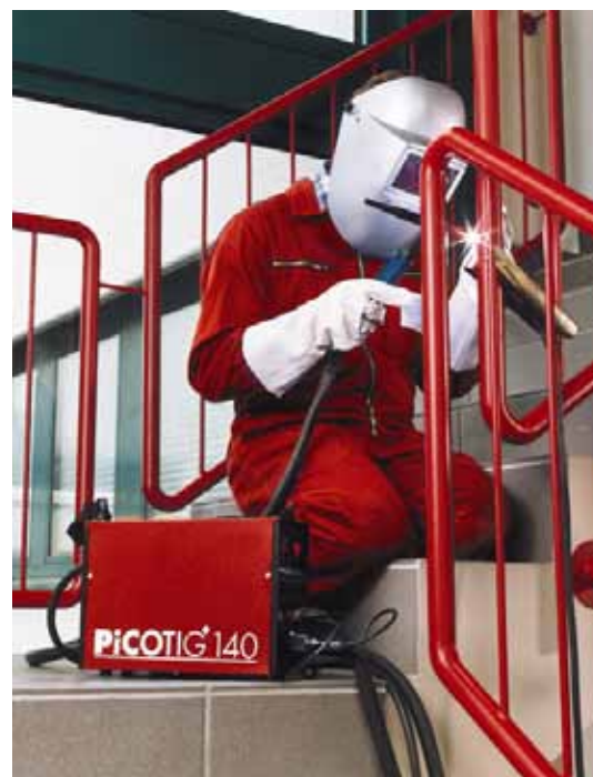
Bild 4 WIG-Schweißen an einem Geländer
