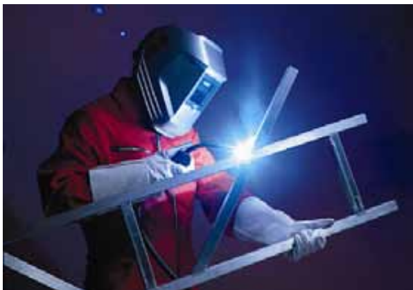
Bild 1 MAG-Schweißen im Handwerksbetrieb
