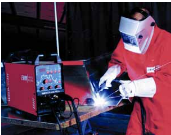
Bild 27 TRITON 220 AC/DC, WIG-Inverter-Schweißgerät
