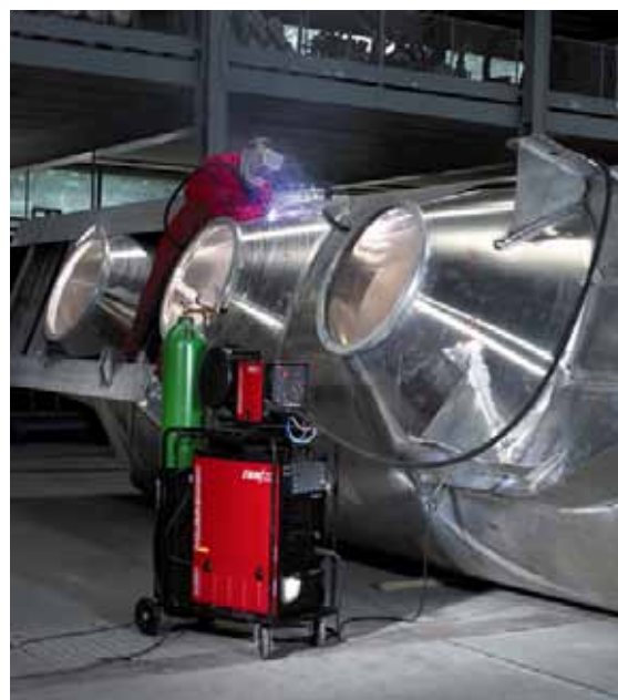
Bild 39 MIG-Aluminium-Schweißen im Fahrzeugbau
