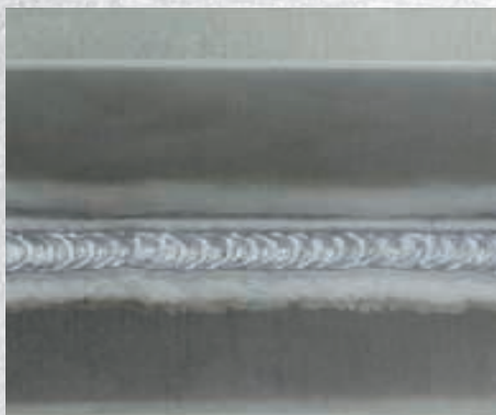
Kehlnaht, 1 mm Blech, AlMg, Argon 1,2 mm Drahtelektrode
