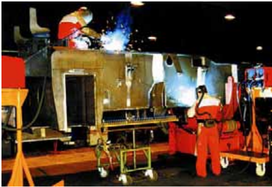
Bild 3 Verschweißen von Feinkornbaustählen im Kranbau
