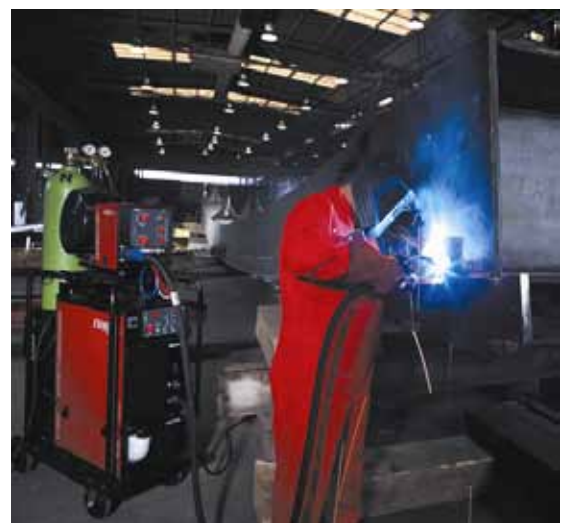
Bild 38 MAG-Schweißen an Trägern im Stahlbau
