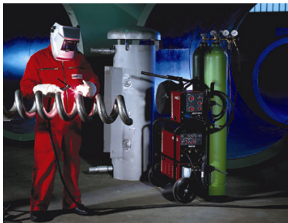
Bild 1 TRITON 260 DC, WIG-Verschweißen von Kühlschlangen
