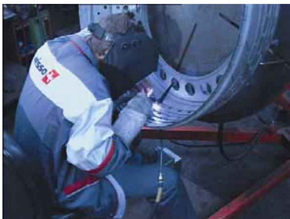
Bild 31 WIG-Schweißen bei der Reparatur von Triebwerksteilen
