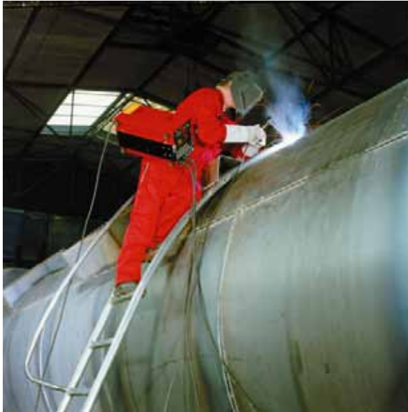
Bild 21 Anwendung des E-Hand-Schweißens im Behälterbau
