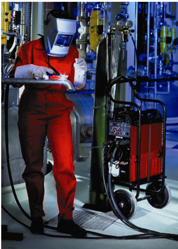
Bild 6 WIG-Schweißerarbeiten in der Chemie-Industrie
