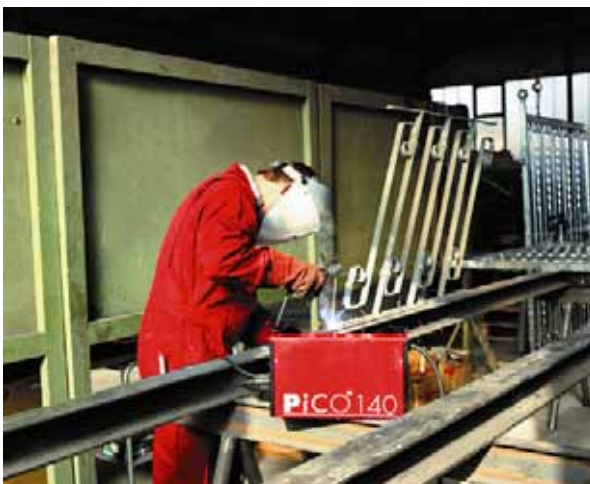
Bild 22 Anwendung des E-Hand-Schweißens beim Geländerbau
