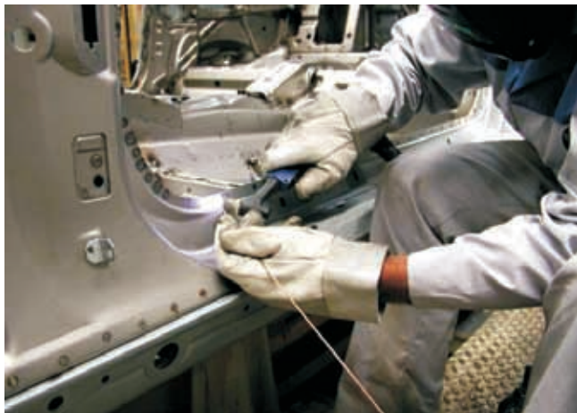
Bild 22: Manuelles Plasmalöten am Türschweller einer BMW-PKW-Karosserie
