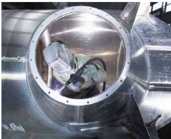
Bild 42 MIG-Schweißen beim Herstellen von Aufliedertanks
